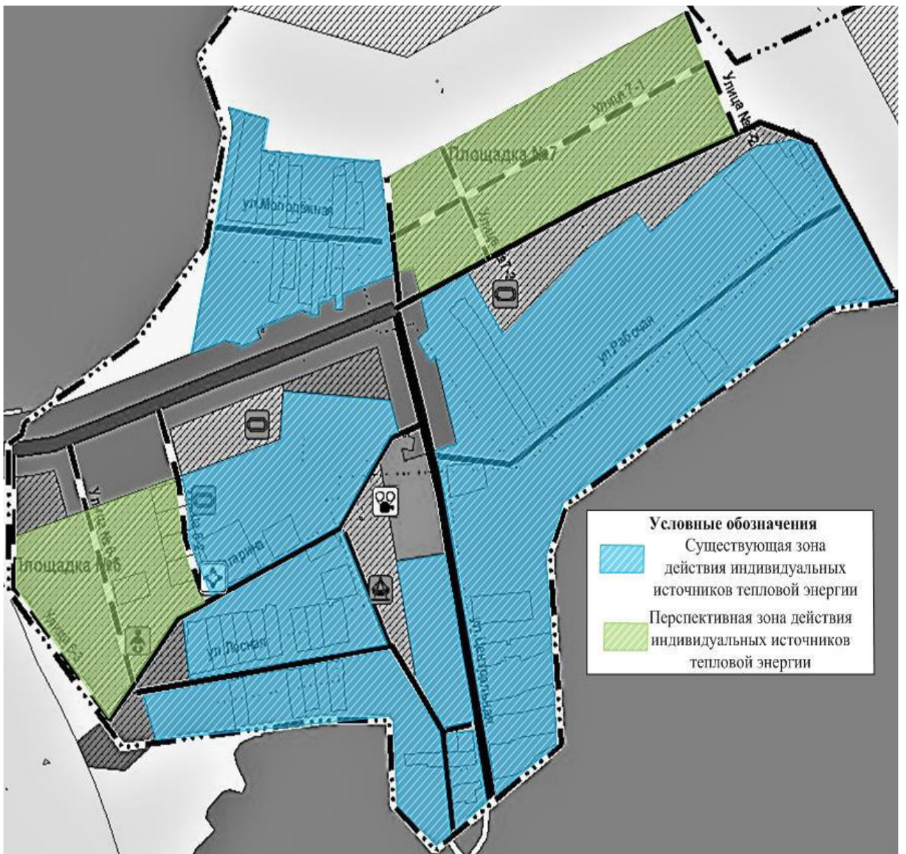
Рис. № 10 – Существующая и перспективная зоны действия индивидуального теплоснабжения на территории поселка Красные Дубки
